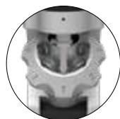
Barillet interchangeable 7 positions faisant office de magasin d'outils et de sélecteur de fonction
