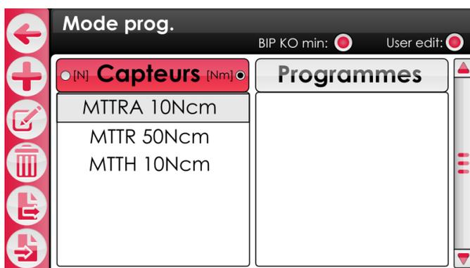
**Figure 19: Ajout de programme après sélection du capteur**
