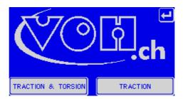
Une nouvelle pression au centre de l'écran vous donne le choix entre les deux modes principaux de tests : traction&torsion ou traction uniquement. Le mode traction est une version allégée du mode traction&torsion, c'est pourquoi uniquement le mode traction&torsion sera détaillé.
