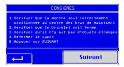
Quelques vérifications sont encore à respecter avant le lancement de la série de tests. Il est primordial de suivre ces consignes de sécurité. Si l'une des consignes ne peut être remplie, revenez à l'écran précédent avec la touche 🛶, sinon validez avec Suivant pour lancer la série tests.
